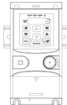
نصب روی ریل
